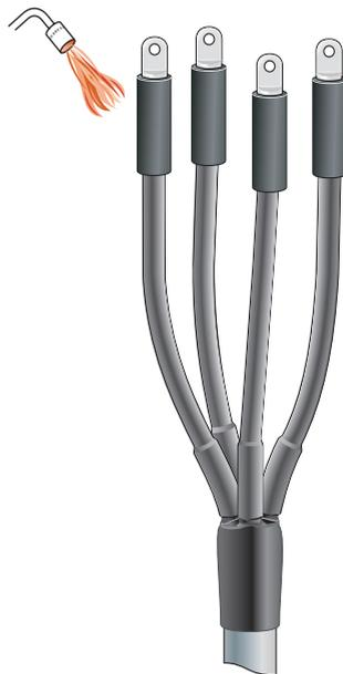
**Монтаж муфты завершен. Дайте муфте остыть прежде чем подвергать ее какому-либо механическому воздействию.**
