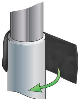
**2.1** Обмотать пластиной-герметиком наружную оболочку кабеля начиная от среза оболочки. Обжать герметик руками.
