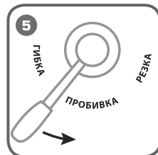
5 Поверните рычаг распределения потока рабочей жидкости в нужное положение в соответствии с указателями
