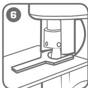
Установите съемник и сбросьте давление.
