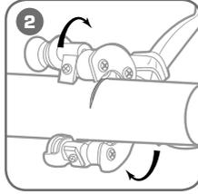
**2** Захватите кабель и, совершая круговые движения вокруг кабеля, разрежьте изоляцию в поперечном направлении.
