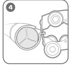
**4** Зажмите край изоляции ножами для захвата и снимите ее с кабеля.
